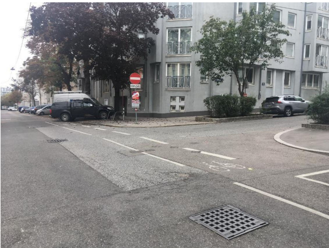
Abbildung 15: durchgezogene Leitlinien trotz Nachrangs (Rechtsvorrang) für den Radverkehr gegen die Einbahn, Kreuzung Zeillergasse # Kainzgasse
