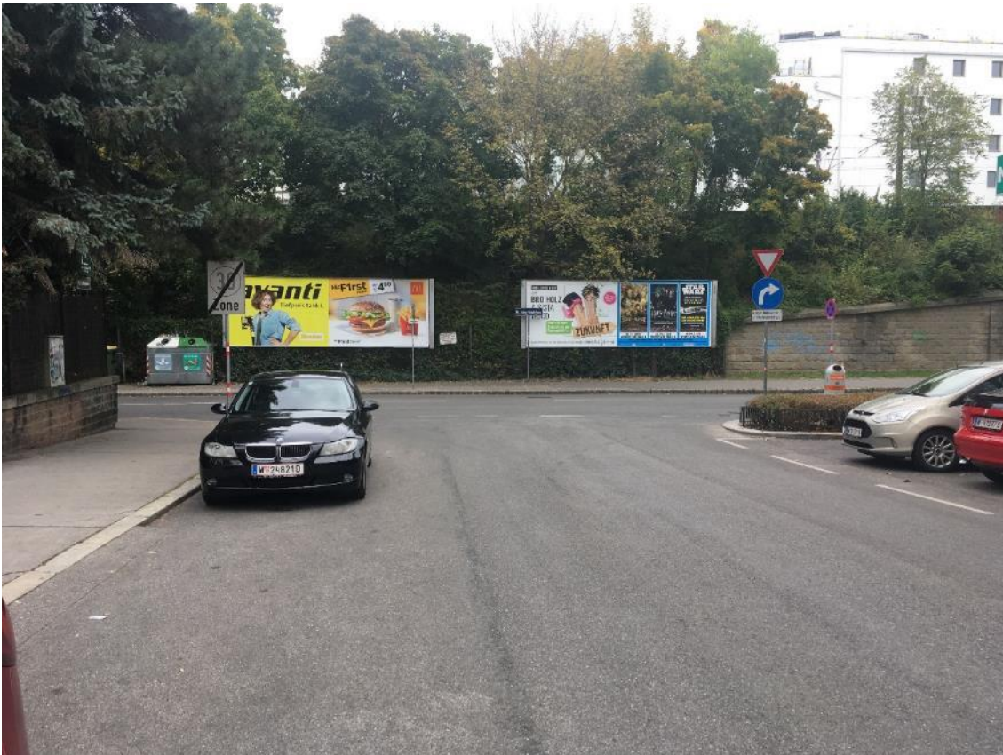
Abbildung 22: fehlende Ausnahme für Radfahrende vom Rechts-Abbiegegebot, Einmündung Liebnechtgasse # Julius-Meini-Gasse
